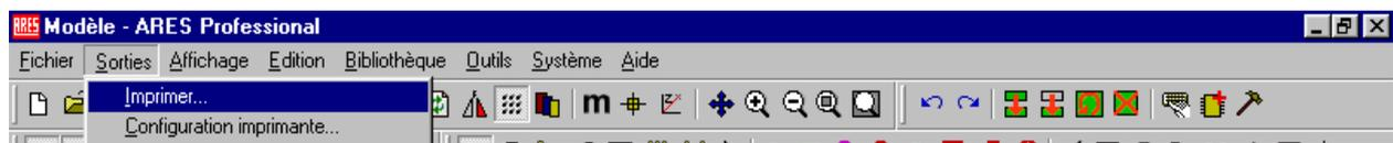
Les impressions ne pouvant se faire que vue par vue, il est nécessaire de recommencer cette opération précédente autant de fois qu'il y a de vues à imprimer, comme le montre les écrans suivants: impression du plan d'implantation (*top silk*), puis du typon côté composants (*top copper*), puis du typon côté cuivre (*bottom copper*).
