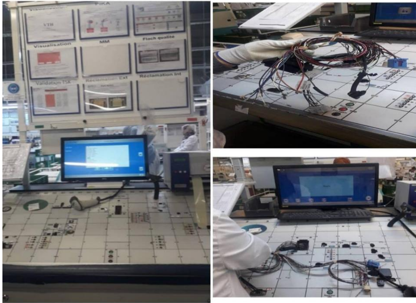
Figure 5: Table test électrique
